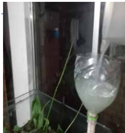
Funcionamiento del Biofiltro el agua llega al fondo e inicia su ascenso pasando por las diferentes capas de grava, carbón y arena de río hasta llegar a la superficie.
